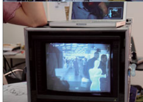
Die On-Set Previz von JDC spiegelt am Set CGI-Grafiken per Video-Insert in den Sucher und per Mixer in den Vorschaumonitor ein.
