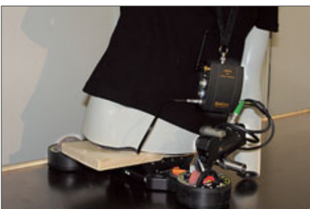
Die On-Set Previz von JDC spiegelt am Set CGI-Grafiken per Video-Insert in den Sucher und per Mixer in den Vorschaumonitor ein.
