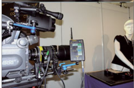
Zweckentfremdeter Skater Mini von P+S Technik als Zielobjekt für den cfinder von cmotion
